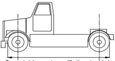
Zone autorisée pour les modifications du châssis Permitted area for the chassis modifications
